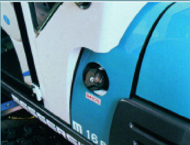
Refuelling access is external to the engine compartment / Der Tank des Kraftstoffes ist von der Aussenseite der Maschine zugänglich / Поддача дизельного топлива является доступной с наружной части машины.
