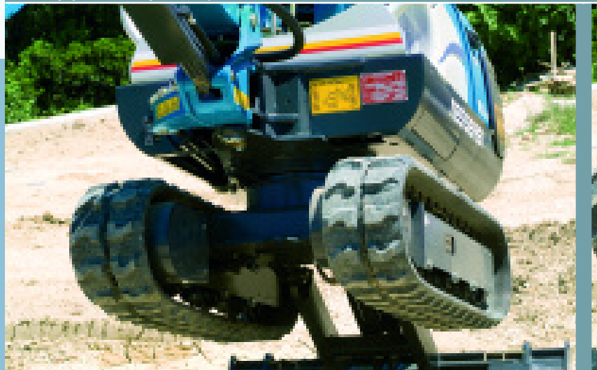
Hydraulic track widening from 1000 mm to 1300 mm (only M-18 BE), with a consequent manual adaptation of the refilling blade / Hydraulische Erweiterung der Raupenspur von 1000 mm bis 1300 mm (nur M-18BE), mit konsequenter Anpassung (manuel) an der neuen Breite vom Eingrabungsbilatt / Гидравлическое расширение колеи от 1000 мм до 1300 мм (только в M-18BE), с последующей ручной регулировкой резака закапывания на новую ширину.
