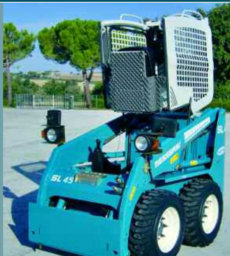
Lifted cab / Aufgehobene Kabine / Поднятая кабина
