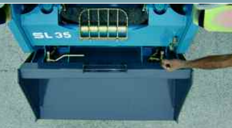
Detail of the quick hitch / Detail Schnellanschluss / Изображение быстрого крепления
