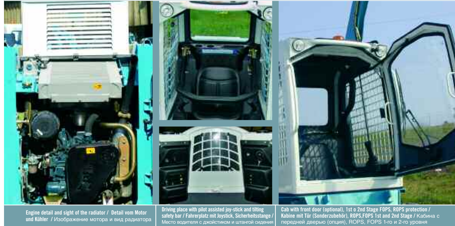
Engine detail and sight of the radiator / Detail vom Motor und Kühler / Изображение мотора и вид радиатора Driving place with pilot assisted joy-stick and tilting safety bar / Fahrerplatz mit Joystick, Sicherheitsstange / Место водителя с джойстиком и штангой сидения Cab with front door (optional), 1st o 2nd Stage FOPS, ROPS protection / Kabine mit Tür (Sonderzubehör), ROPS,FOPS 1st and 2nd Stage / Кабина с передней дверью (опция), ROPS, FOPS 1-го и 2-го уровня
